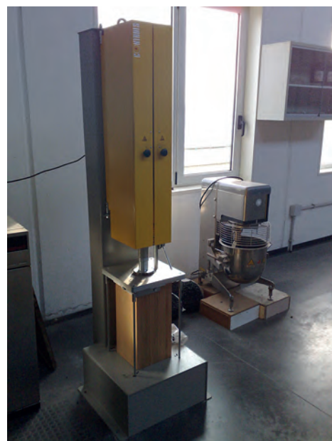
Compattatore Marshall a impatto (UNI EN 12697-30)
