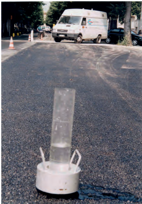
Permeabilità in situ con metodo Belga*
