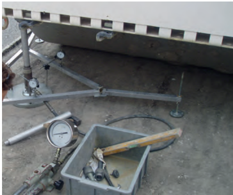
Prova di carico a doppio ciclo con piastra circolare diam. 300 mm. (CNR B.U. n. 146)
