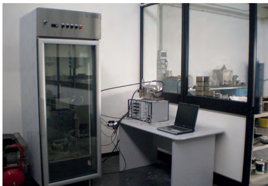
Attrezzatura per prova di modulo e prova di fatica (UNI EN 12697-26 e 12697-24)*
