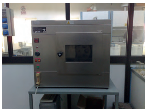
Invecchiamento RTFOT (UNI EN 12607-01)*
