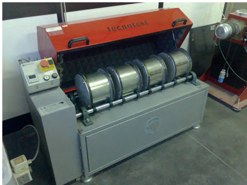
Determinazione della resistenza all'usura (Micro-deval) (UNI EN 1097-8:2001)*
