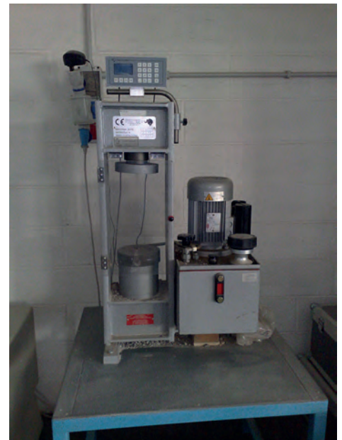
Pressa per misti cementati (CNR BU 29/72)*
