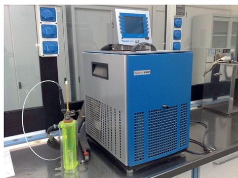
Apparecchiatura per rottura Fraass
