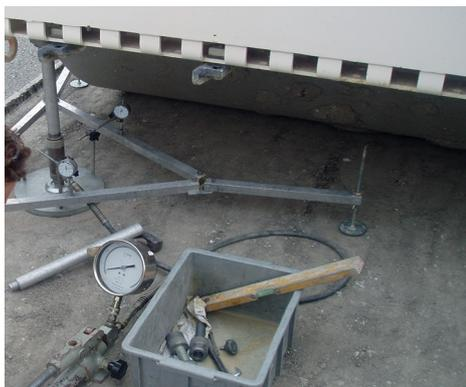
Prova di carico a doppio ciclo con piastra circolare diam. 300 mm.
